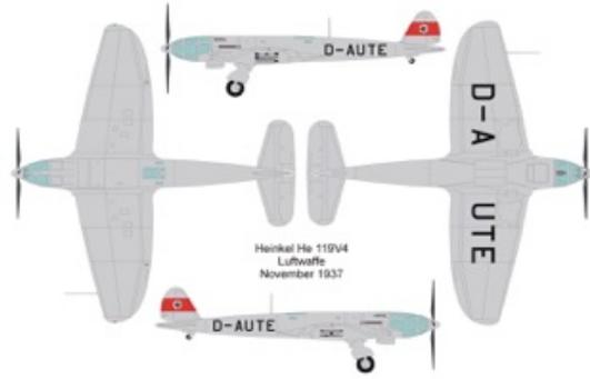
バロムから1/72でヴードゥーが発売となります。RF-101C は偵察機型、F-101C は単座戦闘爆撃機型です。ハインケル He119は高速爆撃機としてエンジンを胴体内部に搭載し延長軸でプロペラに動力を伝えました。よってプロペラ軸がコックピットを貫通することとなりその両脇に1名ずつのパイロットが搭乗しました。8機製造されたうちの2機が1941年に日本海軍に研究用として輸入されました
